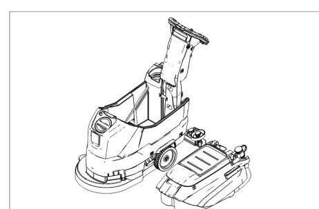
→ Снять резервуар для грязной воды и отставить в сторону.
