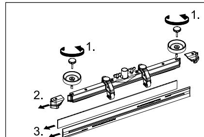
→ Снять пластмассовые элементы.
