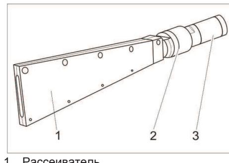
Плоскоструйная форсунка состоит из наконечника подключения насадок и рассеивателя. В качестве принадлежностей доступны наконечники подключения насадок с разными сечениями.
